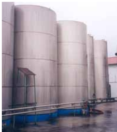
Fig 2.17. Genom dekantering skiljs oljan från vattenfasen.
