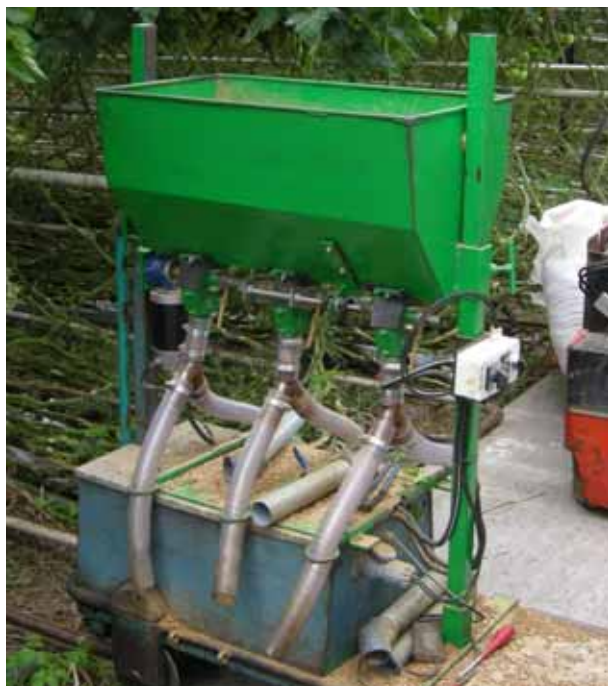
Maskin för rationell tilläggsgödsling med pellets i ekologisk tomatodling i Holland. Foto: Stig Arne Molén
