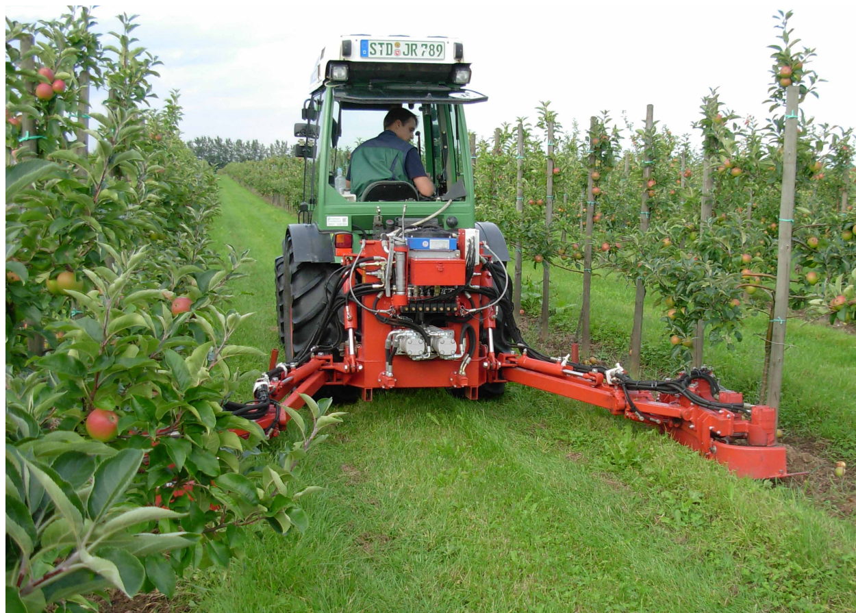
Markbehandling i en stor ekologisk fruktodling med en tvåradig fruktfräs.
