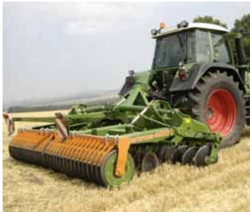
Grundbearbetande, kompakt tallriksredskap med mindre tallrikar. (Foto: Amazone)
