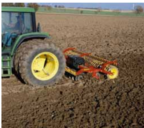
Ett grundbearbetande tallriksredskap kan även användas på plogtilta. (Foto: Väderstadverken)
