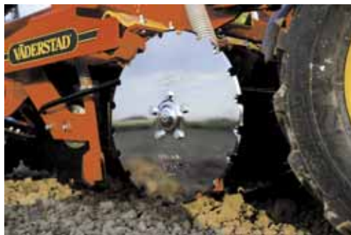
Enkel skivbill för sådd under varierande förhållanden. (Foto: Väderstadverken)
