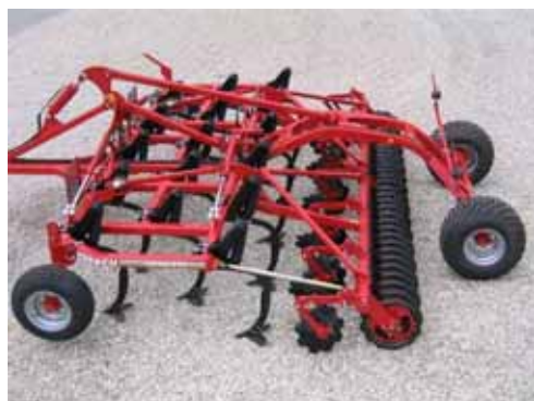
En kultivator med styva pinnar och utbytbara skär är ett flexibelt redskap för bearbetning på olika djup. (Foto: Horsch)
