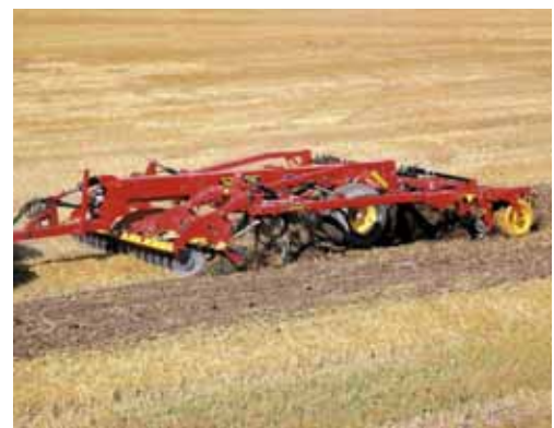
Stubbearbetningsredskap av kombinationstyp med bearbetande tallrikar och kultivatorpinnar. (Foto: Väderstadverken)
