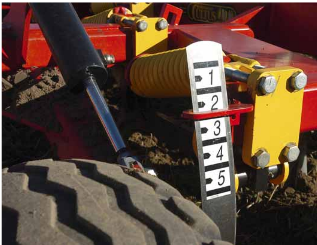
Skala vid inställning av bearbetningsdjup. Foto: Väderstadverken.
