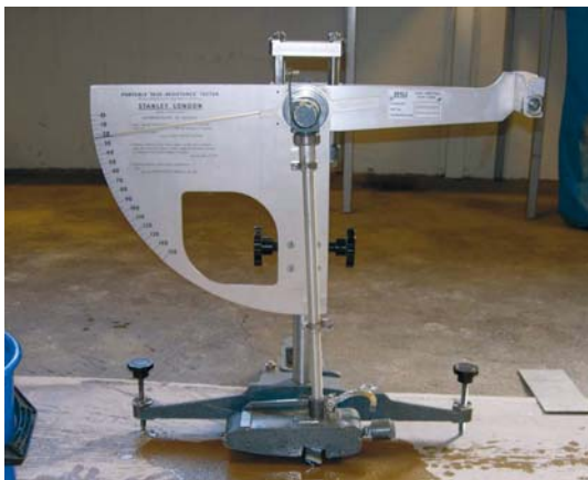
Friktionsmätning med SRT på vattenbelagd yta.
