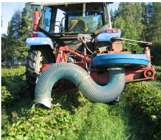
Sugmaskin för bekämpning av insekter. Maskinen är konstruerad av odlare och finns inte att köpa. Foto: Petter Olsson och Mari Ryberg.
