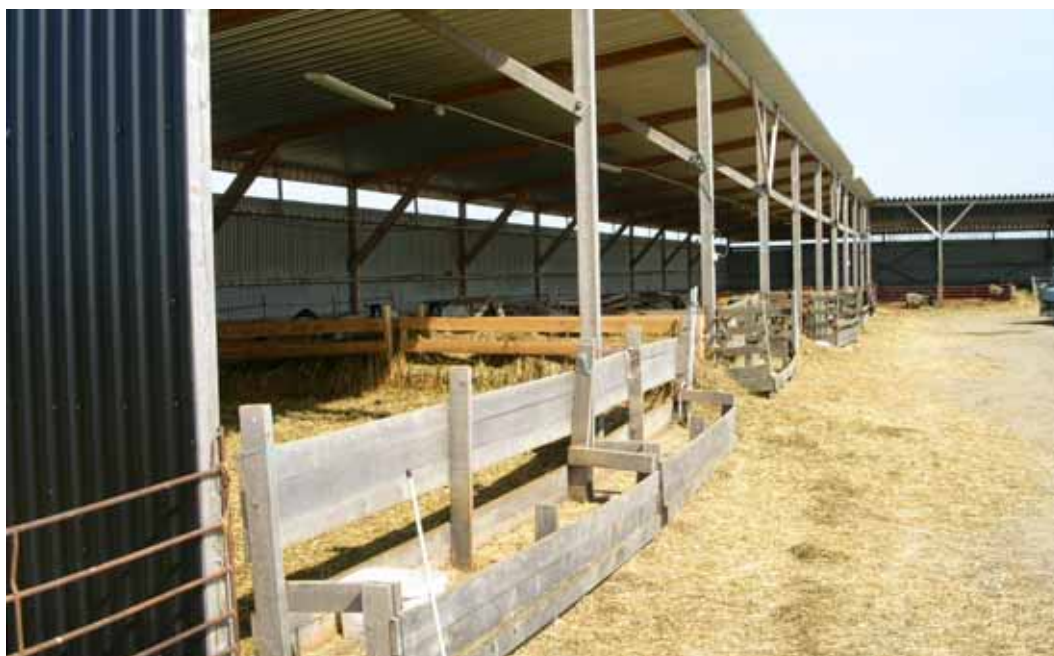
Treväggs hus med öppen långsida och snedtak.
