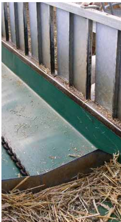
Bandfoderfördelare med låsningsbara foderfronter.
