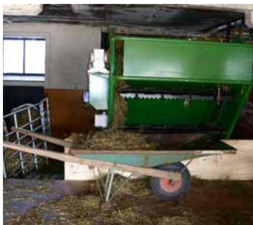
Upprullare till ensilage med skottkärra under.
