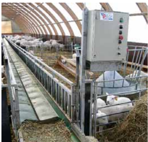
Foderbordet består av en bandfoderfördelare.
