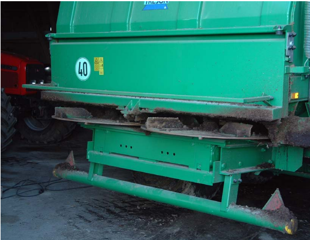
Tvåstegsspridare med spridarvalsar ger en relativt jämn spridningsbild.
