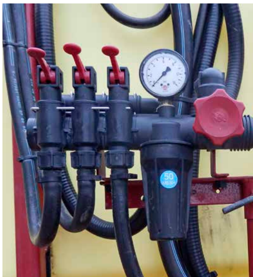
Bild 13. Manometer och sektionsavstängningar.
