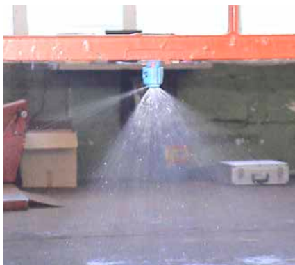
Bild 14 visar ett munstycke som inte har en jämn spridningsbild. Ett sådant munstycke bör leda till att alla munstycken av denna storlek på sprutan bör bytas ut.
