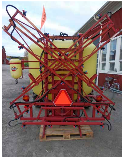
Bild 11. Transportsäkringar ska se till att bommen kan transporteras utan risk. Den grå sprinten snett upp åt höger från LGF skylten är en viktig komponent i detta liksom de plattstål som håller sektionerna på plats. Ett sådant ser man om man följer bommen som sprinten sitter på snett ner åt höger.
