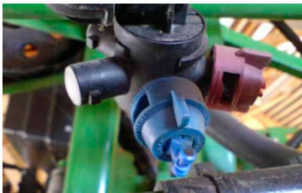
Bild 15. I bilden syns en vit plugg som blockerar en outnyttjad öppning i en flervalshållare.
