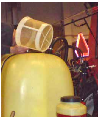
Bild 7. En hel påfyllningssil ska finnas under tanklocket. Arbetar man med något annat än helt oanvända sprutor bör man ha skyddshandskar. På bilden syns även en mindre vattentank som ger möjlighet till avsköljning.
