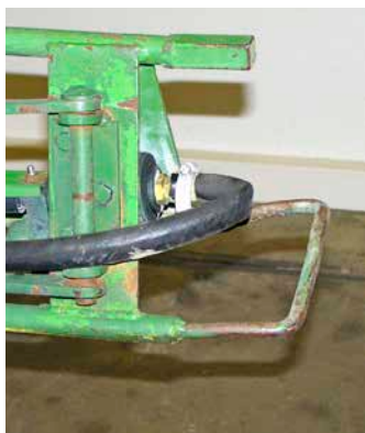
Bild 6. I vecket på slangen som ibland bildas när rampsektionerna fälls ihop bör man kolla särskilt att slangen inte skadats.
