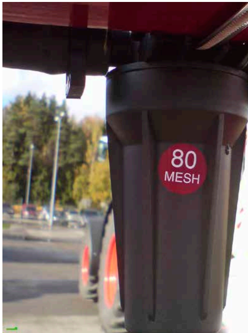
Bild 9 till vänster. Rampfilter med maskstorleken tydligt utmärkt. Vilken maskstorlek filtren ska ha styrs av vilka munstycken man använder. Bild 10 till höger. Tank med ett rör där man kan läsa av vätskenivån i tanken.
