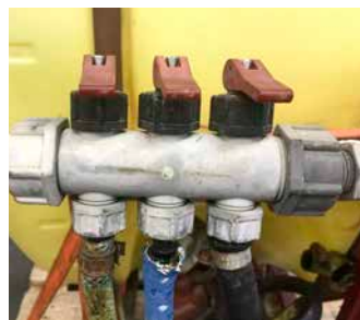
Bild 8. Slitna slangar och dåliga anslutningar. När det är så här olika slangtyper kan det vara en indikation på att fel typ av slang använts.
