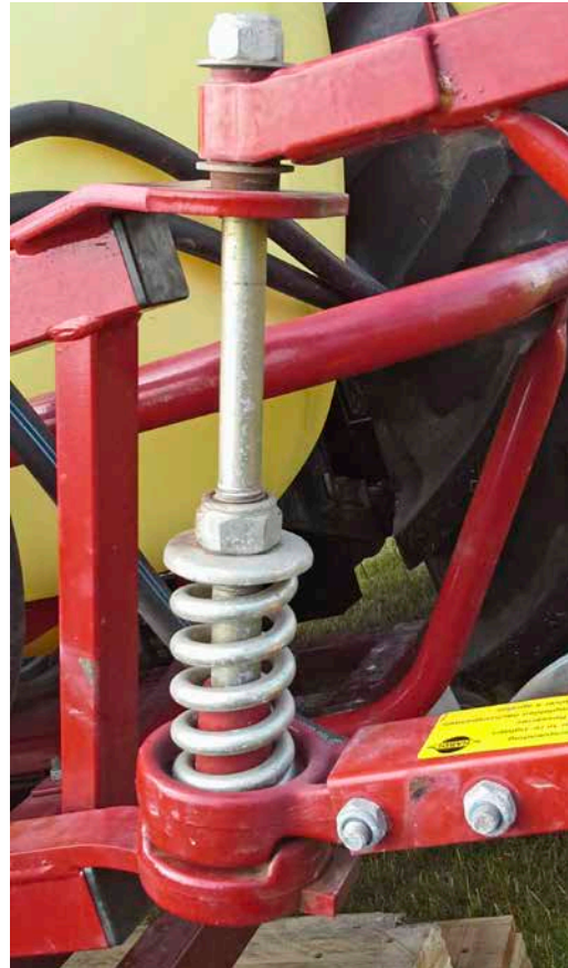
Bild 12. Klacken mellan de två runda järnen under fjädern har en viktig funktion för att sprutbommen inte ska lösas ut för lätt.
