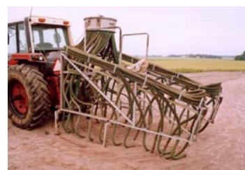
Med matarslangsystem går det att minska på markpackningen jämfört med att köra med en tankvagn. Foto: Håkan Alfredsson
