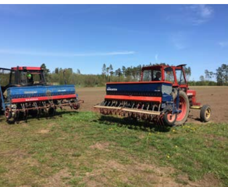
Nordsten såmaskin med släpbillar sprider fröna jämnt, trots att blomsterblandningarna innehåller frön av skiftande storlek och form. Foto: Per Modig.
