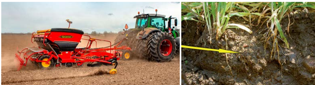
Figur 10 och 11. Med en så kallad kombisåmaskin placeras gödseln under marken på lämpligt avstånd från utsädet. Resultatet blir att rötterna samlas som en "rotboll" runt gödselkornet, vilket gör att grödan tidigt kommer åt näringen och att effektiviteten ökar. Foto: Väderstad respektive Lena Holm, Jordvetaren.
