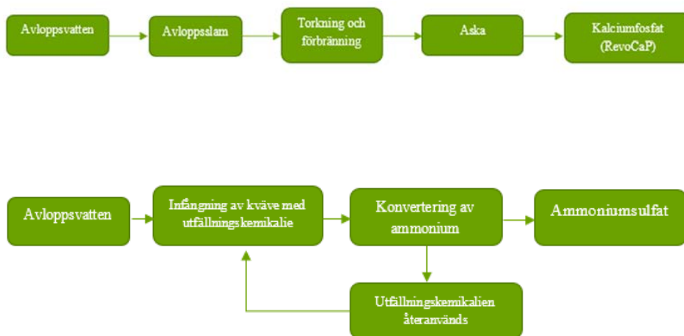
Figur 8. Flödesscheman tekniker Easymining, RevoCaP kallas det färdiga gödselmedel som produceras från aska från avloppsslam.
