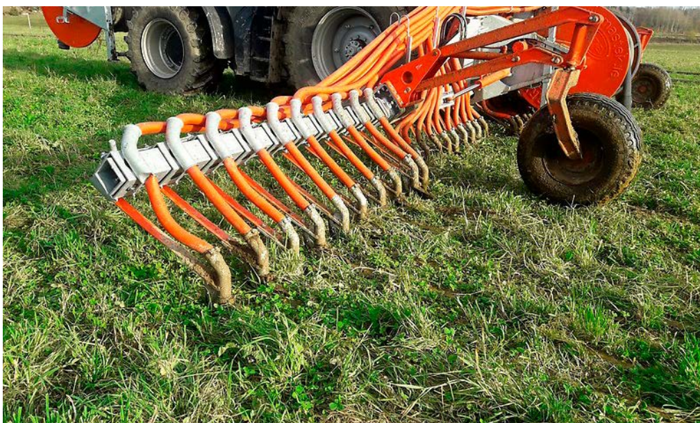
Figur 14. Det finns olika typer av spridare som direkt under spridning placerar gödseln under markytan. Detta är det mest effektiva sättet att använda flytande organiska gödselmedel. (Foto Emelie Andersson)
