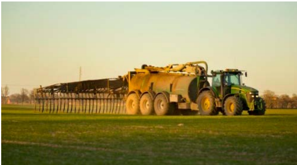
Figur 13. Spridning av flytande organiska gödselmedel med släpplangsutrustning. Gödseln placeras direkt på markytan, vilket minskar förlusterna jämfört med om spegelspridare används. (Foto: Mårten Svensson)
