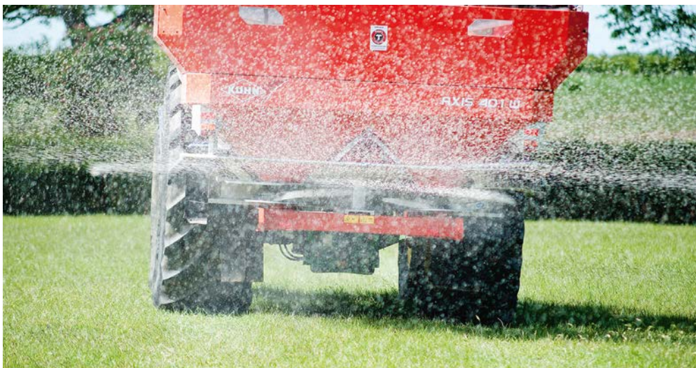
Figur 9. Med en centrifugalspridare sprids gödseln ovanpå markytan. Foto: Yara
