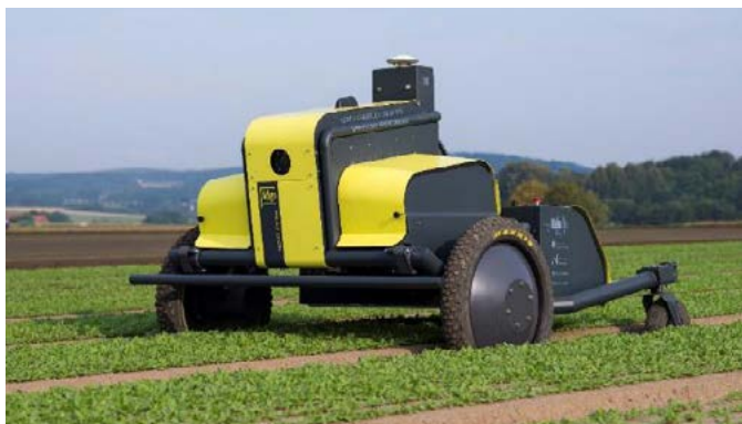
Bild 22. Asterix är en bekämpningsrobot som via bildanalys identifierar enskilda ogräs i grönsaksbäddar och bekämpar dem kemiskt. Foto: www.asterixproject.tech
