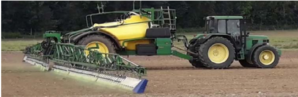
Bild 15. Bogserad bomspruta försedd med släpduk. Foto: www.wingsprayer.com
