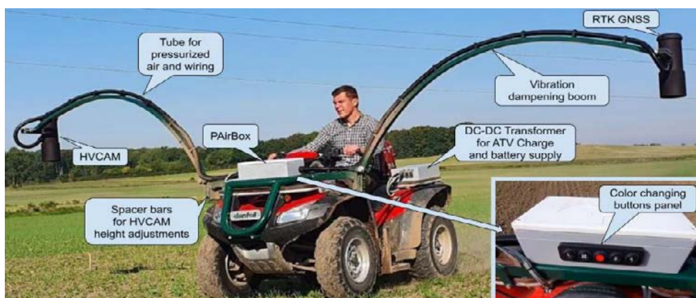
Bild 30. ATV utrustad med 2 kameror för skanning av ogräsförekomsten i fält. Bild: Patriotisk Selskab
