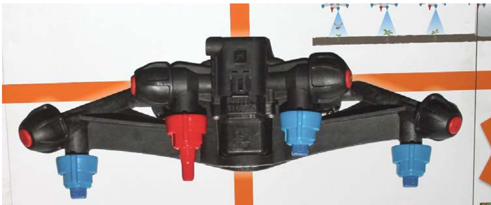
Bild 10. Munstyckshållare med möjlighet till radsprutning. Foto: Christer Johansson
