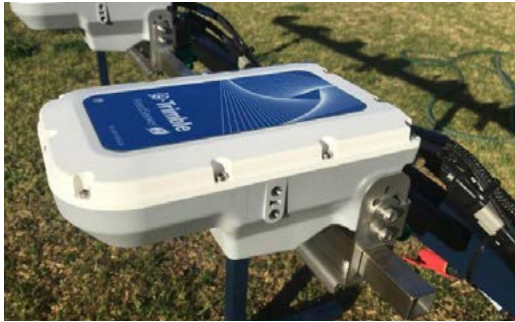
Bild 28. Kameran sensor med bildanalys som sektionvis styr en bomspruta för ogräsbekämpning. Foto: www.ag.trimble.com
