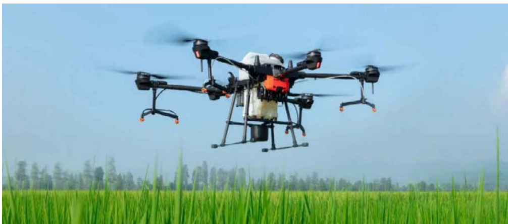
Bild 5. Drönare för spridning av växtskyddsmedel. DJI AGRAS T20, Foto: www.dji.com
