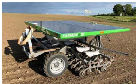
Bild 21. Roboten Farmdroid hackar ogräs i ekologiska sockerbeter utanför Malmö i maj 2020. Foto: Frans Johnson, Jordbruksverket.
