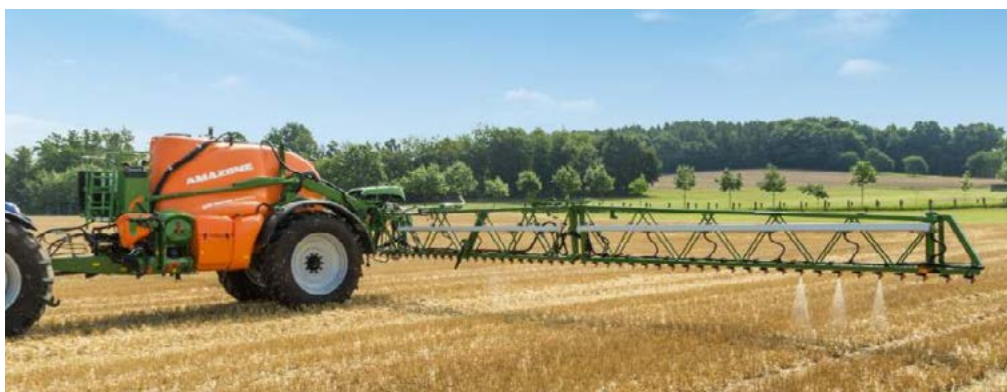
Bild 13. Teknik för punktbekämpning, Amaspot. Foto: www.amazone.de
