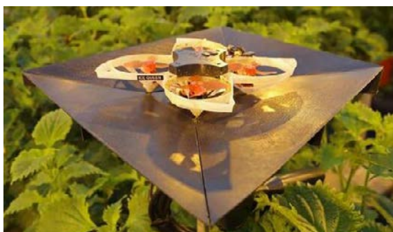
Bild 6. Drönarfladdermus för bekämpning av fjärilsmott i växthus. Foto: www.koppertcress.com
