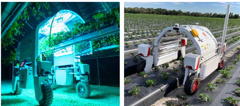
Bild 23. UV-behandling mot mjöldagg i jordgubbar fungerar både i tunnlar och i frilandsodlingar men måste ske nattetid för att ge bra effekt. Foto: www.sagarobotics.com
