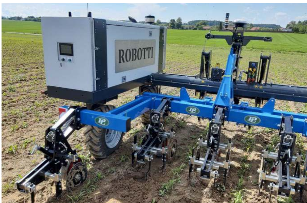
Bild 19. Robotti från Agointelli är en dieseldriven redskapsbärare med hydrostatisk drift. Foto: www.agointelli.com
