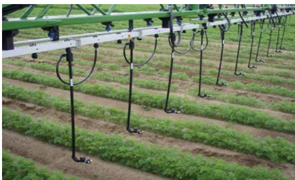
Bild 16. En sprutbom med så kallade Droplegs. Bild: www.amazone.de
