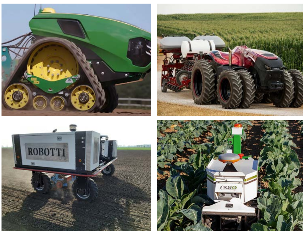
Bild 7. Autonoma traktorer, från vänster eldrivet från John Deere, dieseldrivet från CNH och Agrobot samt eldrivet från Naio OZ. Foto: John Deere, CNH Industrial, Agrobot och Naio Technology.
