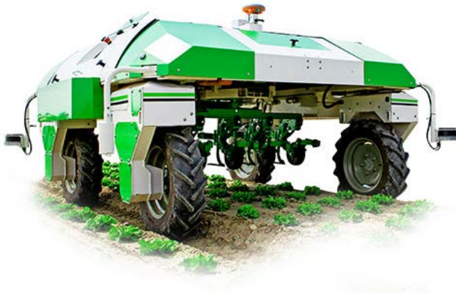
Bild 20. Naio Dino är en autonom redskapsbärare för rad-/bäddodling som kan utrustad med flera olika arbetsorgan. Foto: www.naio-technologies.com
