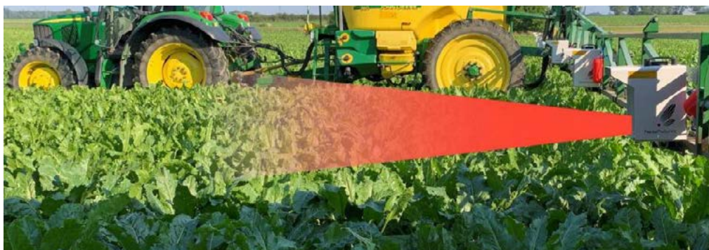
Bild 26. Försök med punktbekämpning av insekter med hjälp av sensorförsedd sektionstyrd bomspruta. Foto: www.FaunaPhotonics.com .
