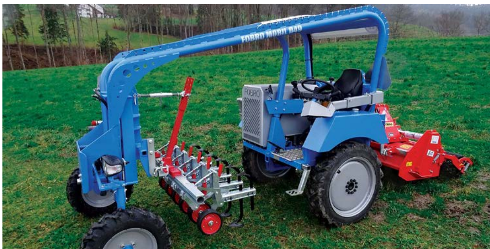
Bild 18. Fobro-Mobil är en manuellt styrd redskapsbärare som används i bäddodlingar av grönsaker. Foto: www.Baertschi.com
