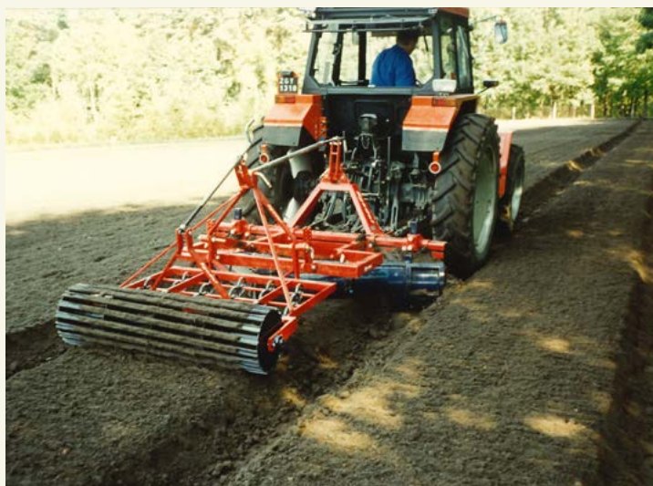
Bäddharv till vänster med kraftiga fräsaggregat som bearbetar och vänder på jorden. Foto AT Fordonsservice. På bäddformaren i bilden till höger har en bäddharv och tryckrulle kopplats på för att kunna arbeta ytligt i bädden. Foto Egedal.
