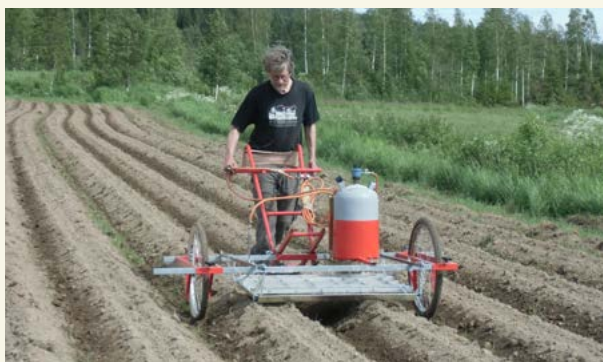
Skjutbar redskapsbärare med justerbar bredd och flera tillbehör. I bilden pågår flamning. Foto Elomestari
