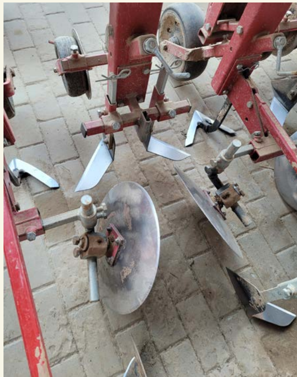
Exempel på olika radhackningsredskap som fingerhjul, gåsfötter och tallrikar i olika storlekar.
