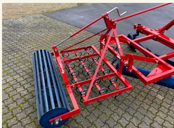
Bäddharv som till exempel kan användas när man arbetar med falska såbäddar. Foto Egedal.
