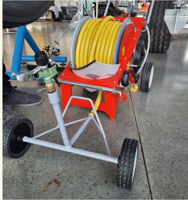
Vattentrycket förflyttar spridaren på hjul.
