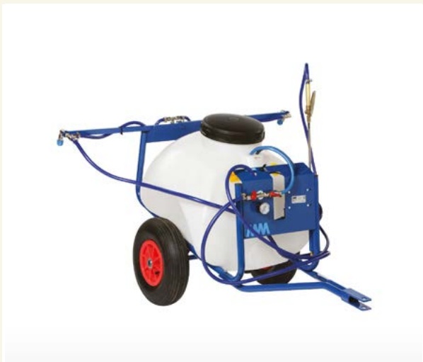
En växtskyddsspruta på 70 liter som kan kopplas till en fyrhjuling. Foto P-Lindberg.
