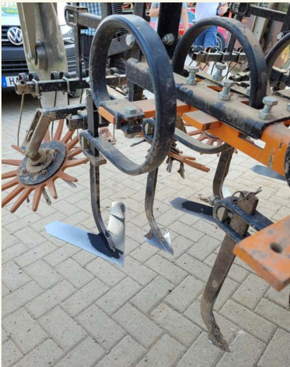
Exempel på olika radhackningsredskap som fingerhjul, gåsfötter och tallrikar i olika storlekar.
