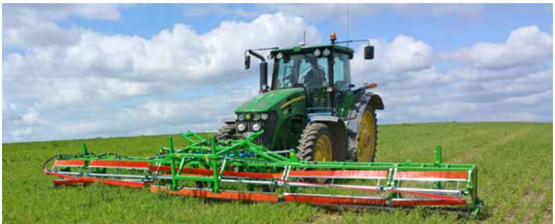
Figur 9. Ogräskärare i spannmål. Före stråskjutning skär ogräskäraren selektivt mot åkertistel och åkermolke. Foto: Jonas Carlsson.
