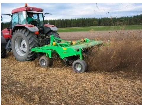
Kvickrotskultivatoren sorterar upp rötterna på ytan. Foto: Johan Jakobsson
