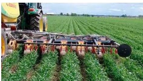
Radhackning av stråsäd sådd med dubbla radavstånd.
