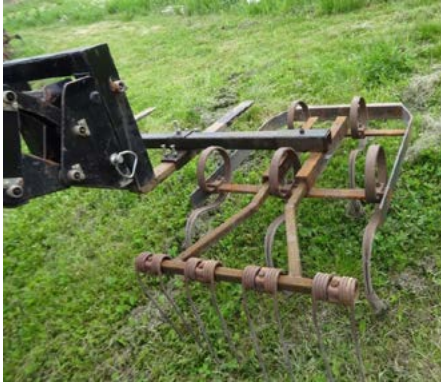
Figur 10. En gammal fjäderharv monterad sidoställd på traktorns pallyftare kan göra ett bra jobb intill raderna och är en mycket kostnadseffektiv investering.
