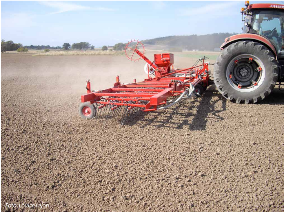
Bild 7. Blindharvning på hösten med en ogräsharv med raka pinnar.
