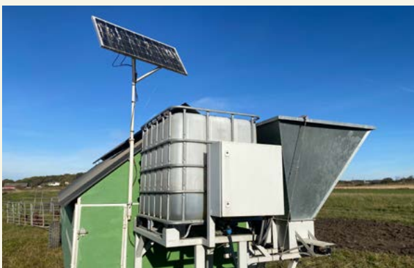
Solcellsdriven serviceenhet med foder och vatten.
