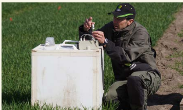
Bild 5, 6. Till vänster mätning av lustgasemissioner i gastäta kammare. Gas som avges från marken ackumuleras i kammaren och emissioner beräknas utifrån hur snabbt koncentrationerna ökar. Till höger ramen som slagits ner i marken med en ränna som fylls med vatten där kammaren ställs.
