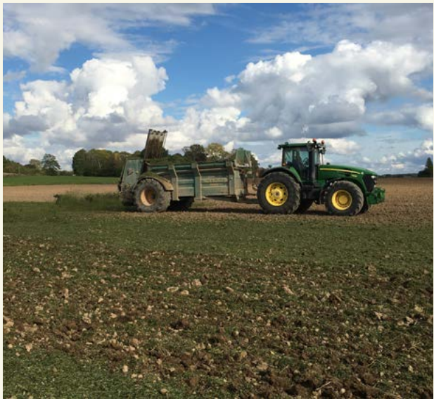
Bild 7, 8. Det är effektivt om skörden görs direkt från fälthacken i en stallgödselspridare och sedan sprids i ett närbeläget fält. En stallgödselspridare med tallrikar i botten sprider materialet jämnt.
