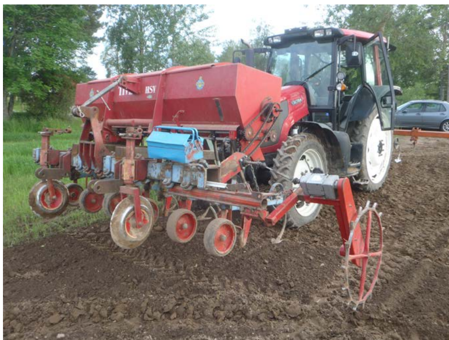
Radgödsling med pellets med ett hemmabyggt ekipage. Foto: Åsa Rölin.
