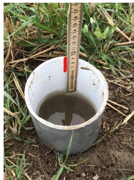
Du kan själv göra ett enkelt test som visar infiltrationen i din jord. Foto: Åsa Rölin.
