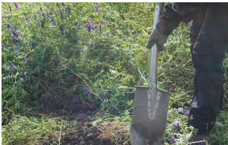
Med en spade kan du enkelt bedöma markens mekaniska motstånd när du gräver en grop. Observera kompakta skikt och hur genomtränglig alven är. Foto: Sara Furenhed.
