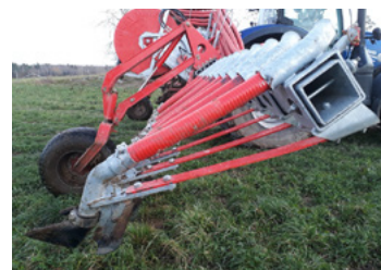
Bild 19. Med släpfot får man en bättre markkontakt. Foto: Johan Malgeryd
