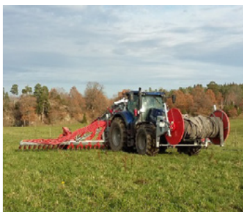
Bild 18. Med matarslangsystem går det att minska markpackningen jämfört med att köra med en tankvagn. Foto: Christer Johansson
