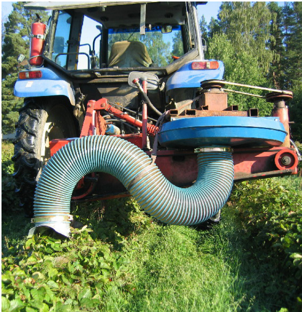
Sugmaskin för bekämpning av insekter. Maskinen är konstruerad av odlare och finns inte att köpa. Foto: Petter Olsson och Mari Ryberg.
