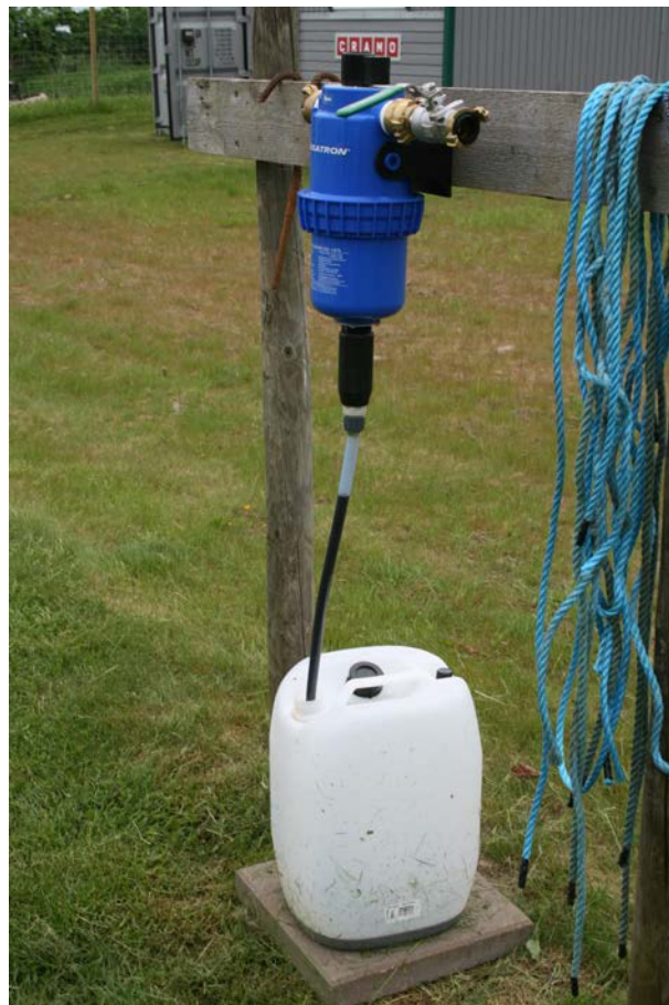
Flytande organiska gödselmedel kan tillföras via droppbevattning med en proportionalitetsblandare.
