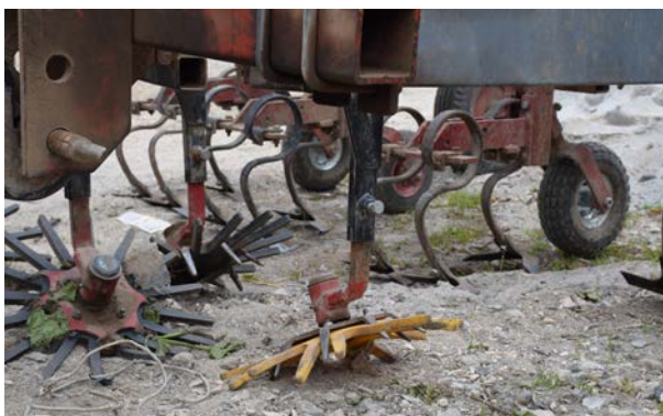
Fingerhjul och gåsfotskär gör att radhackan kan bearbeta jorden nära intill plantorna.
