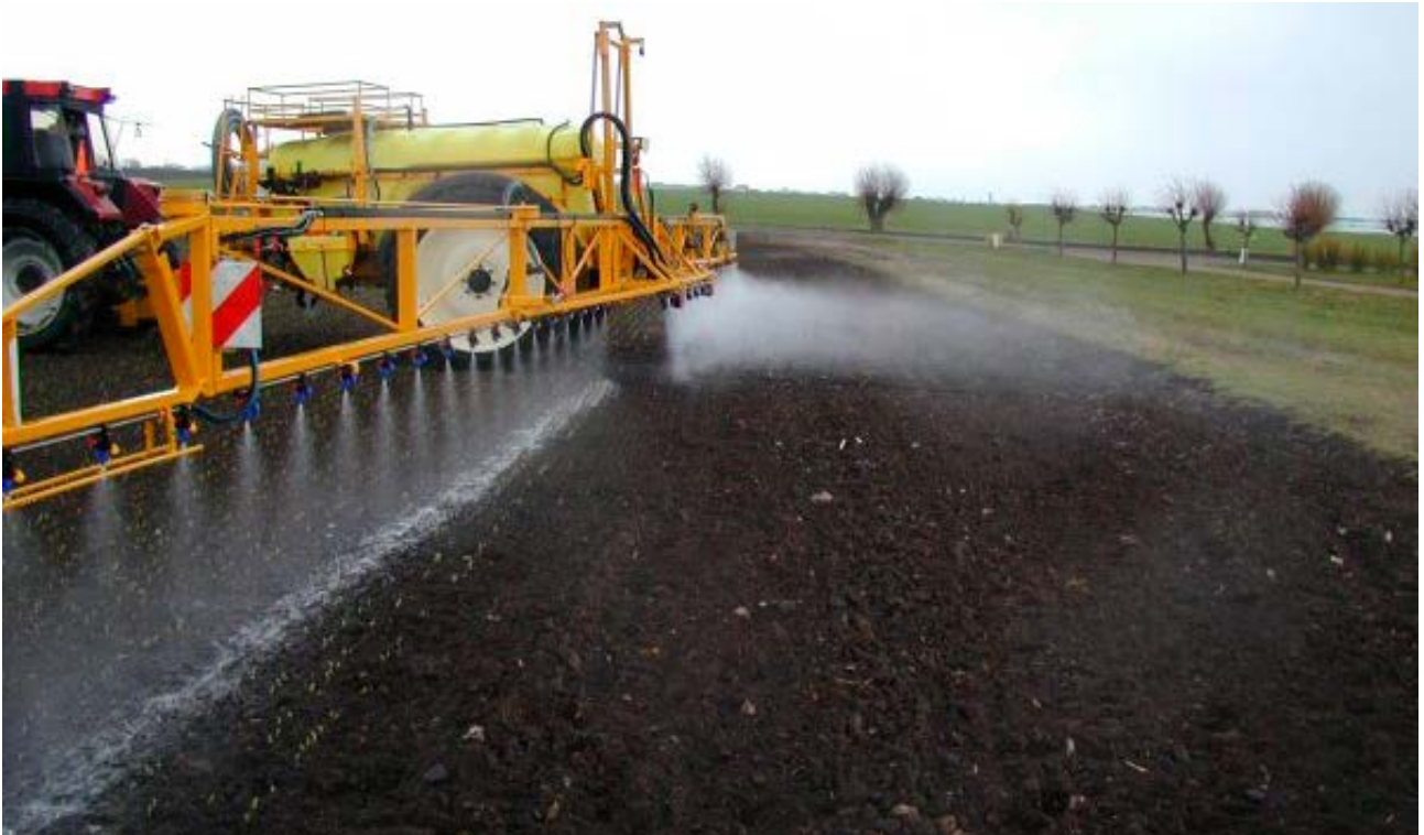
Spruta med injektormunstycken på den närmaste rampdelen och vanliga spaltspridare på den borte rampdelen. Foto: Magnus Sandström
