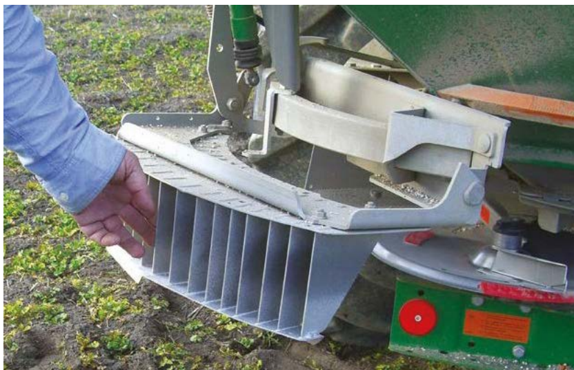
Bild 15. Kantspridningsutrustning minskar risken för att gödsel hamnar utanför fältet. Foto: Jens Blomquist
