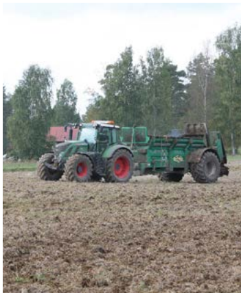
Bild 21. Tvåstegsspridare som sprider fastgödsel.
