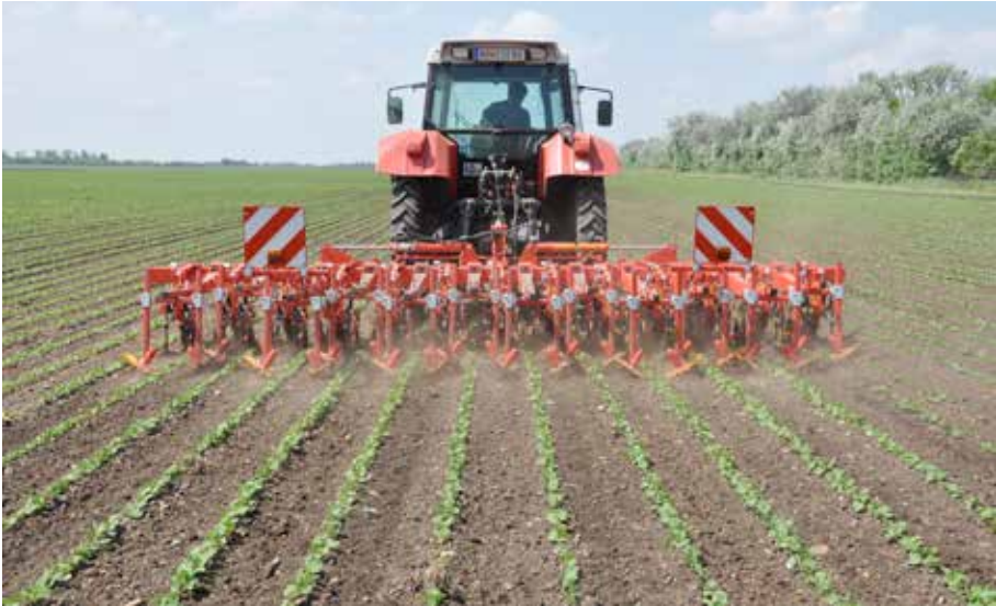
Figur 28. Radrensare Einböck Chopstar (Einböck, www.einboeck.at ).
