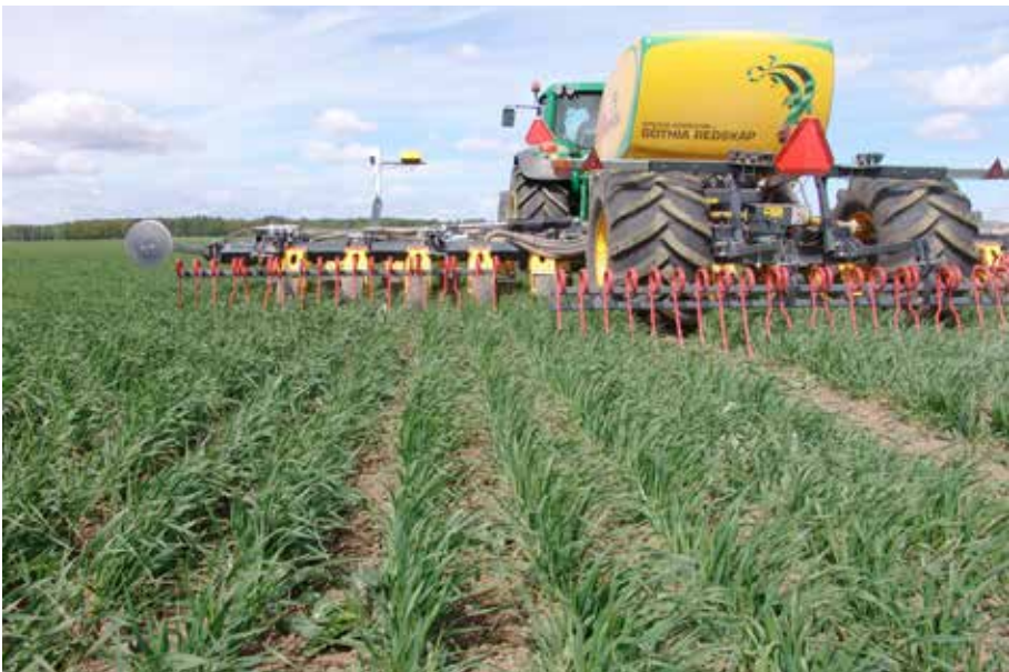
Figur 29. Kombinationsredskap System Cameleon utrustad med kamerastyrning (Gothia Redskap, www.gothia-redskap.se ).
