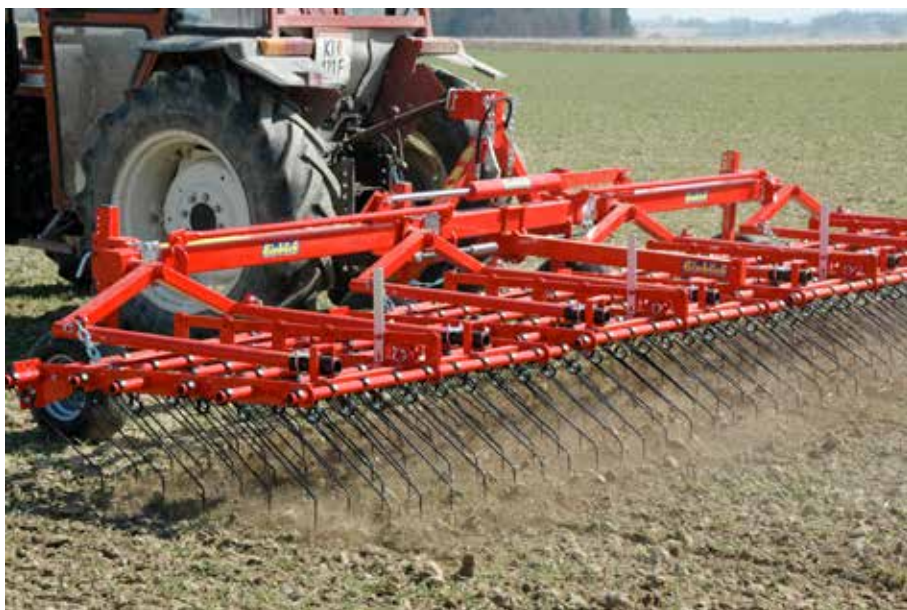
Figur 27. Ogräsharv Einböck Aerostar (Einböck, www.einboeck.at/ ).
