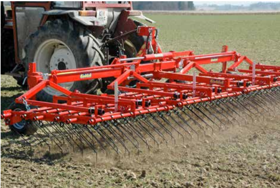
Figur 27. Ogräsharv Einböck Aerostar (Einböck, www.einboeck.at/ ).
