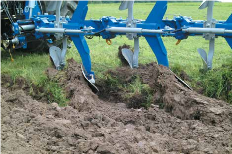
Figur 25. Skumrist på växelplog, som skär loss ytskiktet från tiltan och lägger ner det på plogbotten (Överums Bruk AB, www.overums-bruk.se ).
