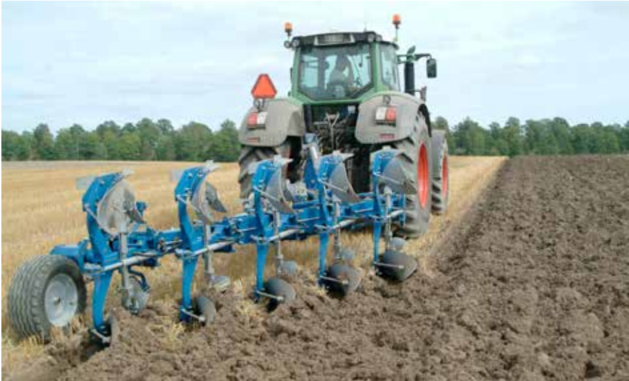
Figur 24. Växelplog (Överums Bruk AB, www.overums-bruk.se ).
