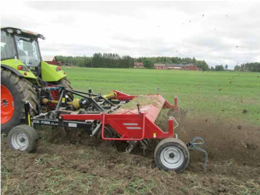
Figur 22. Kultivator KVICK-FINN Light 3000x3 (Oy Ekotjänst Lindgård Ab, www.ekotjanst.fi ).
