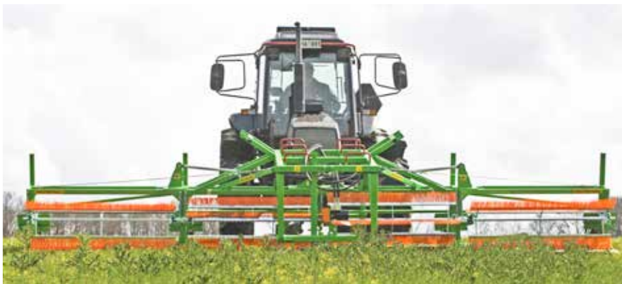
Figur 30. Ogräskäraren CombCut (JustCommonSense AB, www.justcommonsense.eu ).
