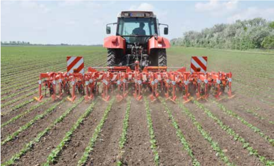
Figur 28. Radrensare Einböck Chopstar (Einböck, www.einboeck.at ).
