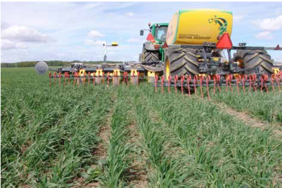
Figur 29. Kombinationsredskap System Cameleon utrustad med kamerastyrning (Gothia Redskap, www.gothiareskap.se ).
