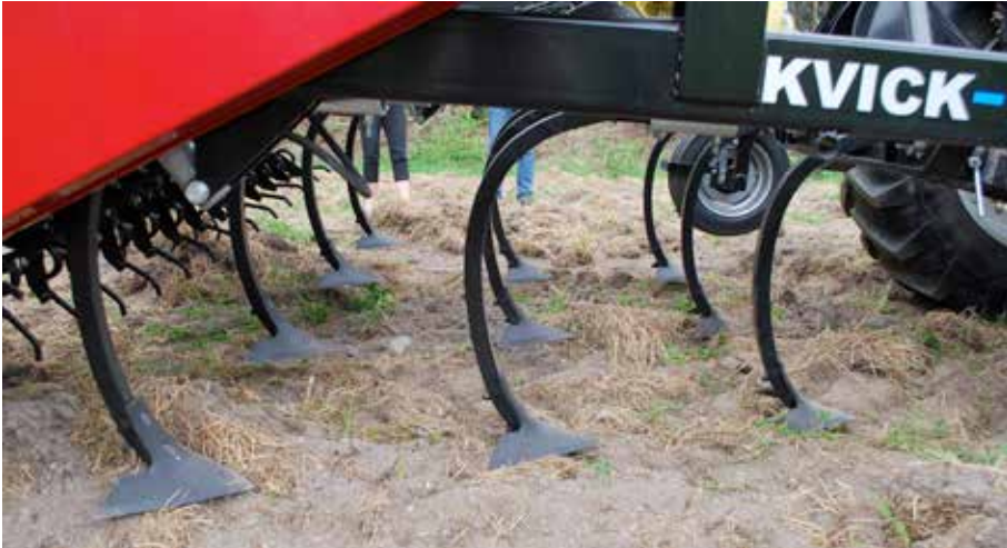
Figur 23. Gåsöfoter på kultivator KVICK-FINN Light 3000x3 (Oy Ekotjänst Lindgård Ab, www.ekotjanst.fi ).
