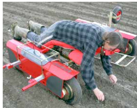
Crawler är en batteridrivna arbetsvagn från Elomestari som kan användas för ogrärensning, plantering och skörd.
