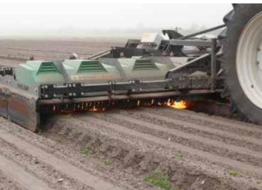
Envo-Dan flamaggregat för bredflamning i större odlingar. Foto: Envo-Dan.
