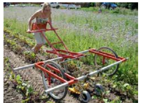
Små fingerhjul kan monteras på redskapsbäraren Weed Master för ogräsbekämpning i raden.
