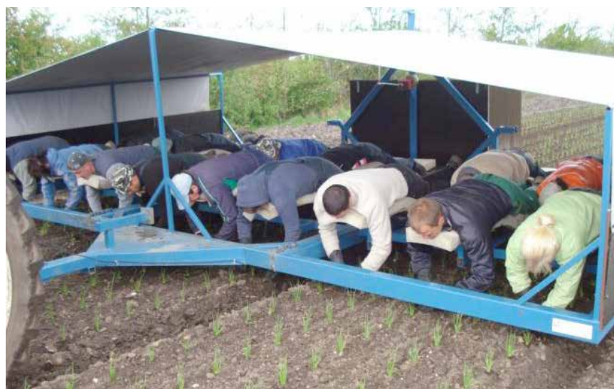
Traktordragen arbetsvagn från Yding Smedie som kan tillverkas med olika antal arbetsplatser. Ekippet på bilden har plats för 17 personer. Bild: Yding Smedie.
