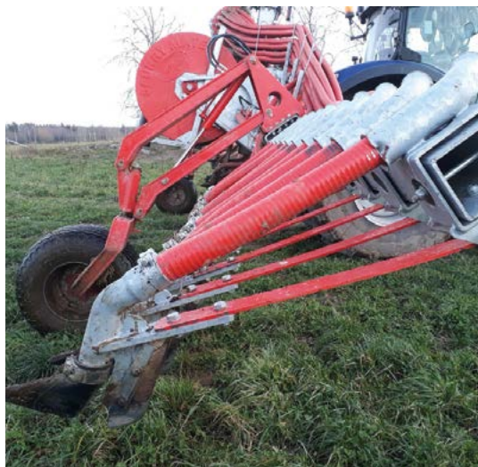
Bild 19. Med släpfot får gödseln en bättre markkontakt. Foto: Johan Malgeryd.
