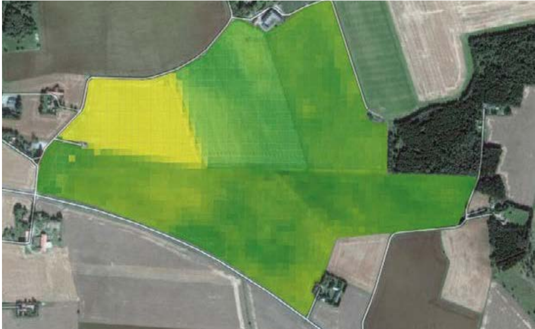
Bild 22. I CropSAT kan du skapa tilldelningsfiler som kan användas för att styra spridare utifrån satellitbilder baserade på vegetationsindex. Foto: Cropsat.se.
