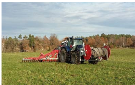
Bild 18. Med ett matarslangsystem går det att minska markpackningen jämfört med att köra med en tankvagn. Foto: Christer Johansson.
