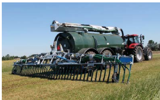
Bild 17. Gödseltunna eller tankvagn är det vanligaste sättet att transportera och sprida flytgödsel. Tankvagnen kan förses med olika typer av spridaraggregat, på bilden en släpfotsramp. Foto: Christer Johansson.
