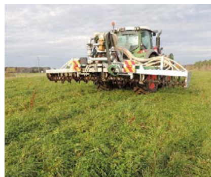
Bild 20. Spridning med matarslang och ytmyllningsaggregat för spridning i vall minskar både markpackning och ammoniakförluster. Foto: Pernilla Kvarmo.
