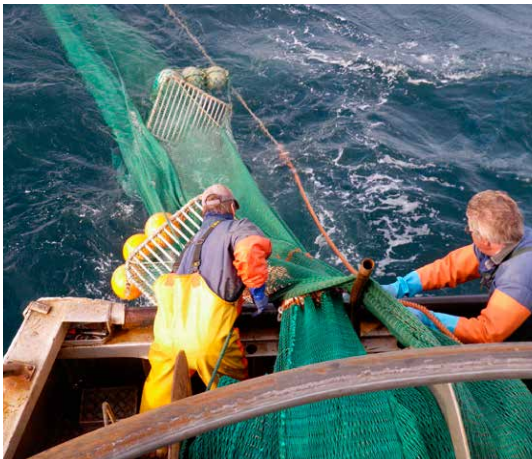
Selektiv kräfttrål. Fotot kommer från SLU Aquas hemsida och visar två yrkesfiskare som genomför ett test av en ny kräfttrål med en rist. Risten fungerar som ett sorteringsgaller och sorterar bort oönskade arter. Foto: Hans Nilsson
