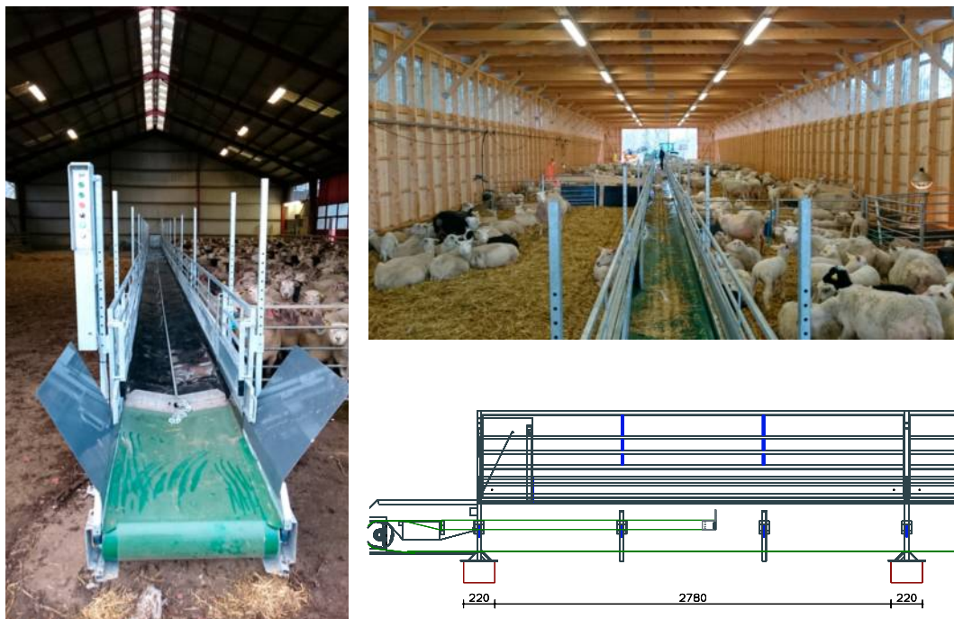
Bild 7, 8 och 9. Denna nya typ av bandfoderborden kan höjas 50 cm allteftersom ströbädden växer och kräver ingen gjuten sockel. Foto Richard van der Poel
