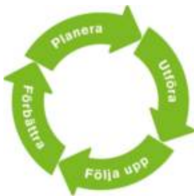
Figur 9. Beskrivande modell över PUFF Snurran eller PDCA cykeln som beskriver de olika stegen i förbättringsarbetet. Själva motorn i förbättringsarbetet som aldrig tar slut. Denna cykel är ständigt i rörelse.
