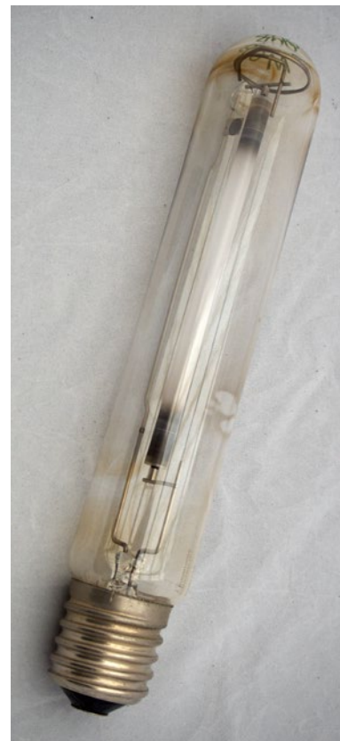
En uttjänt högtrycksnatriumljuskälla. Notera att det finns bruna natriumbeläggningar på insidan av ytterhöljet. Keramikcyindern inne i ljuskällan har svartnat i ändarna, vilket också visar att den är uttjänt och behöver bytas.
