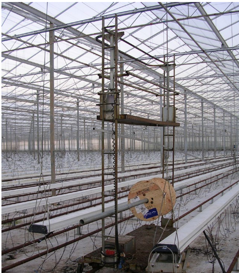
Arbetsvagn för en tomatodling, som drivs av ett 12 Volts bil-batteri och en liten elmotor. Elmotorn kan i vissa fall vara en begagnad vindrutetorkar-motor. Uppe på plattformen finns det 2 brytare i golvet, 1 för att du ska kunna köra vagnen framåt och 1 för att köra vagnen bakåt.
