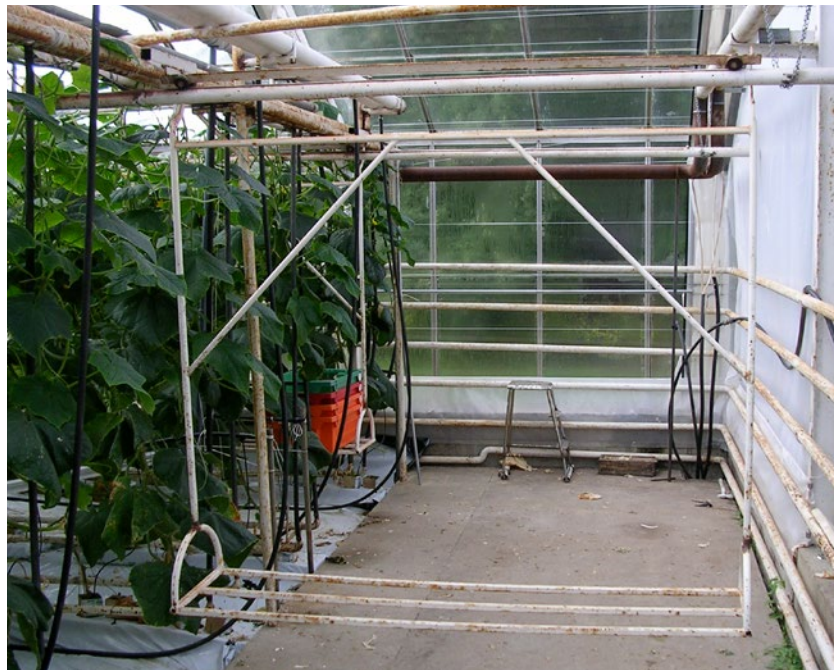
Hemmabyggt vagn som rullar på rör i taket. Vagnen kan användas i alla typer av odling, både grönsaker och prydnadsväxter.
