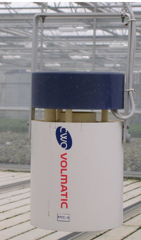
Temperatur- och luft-fuktighetsgivare från DGT-Volmatic. Själva givarkropparna sitter inne i lådan, vilket är viktigt för att förhindra att solstrålningen ska påverka mätningen. Inne i lådan sitter en fläkt för att byta ut luften.
