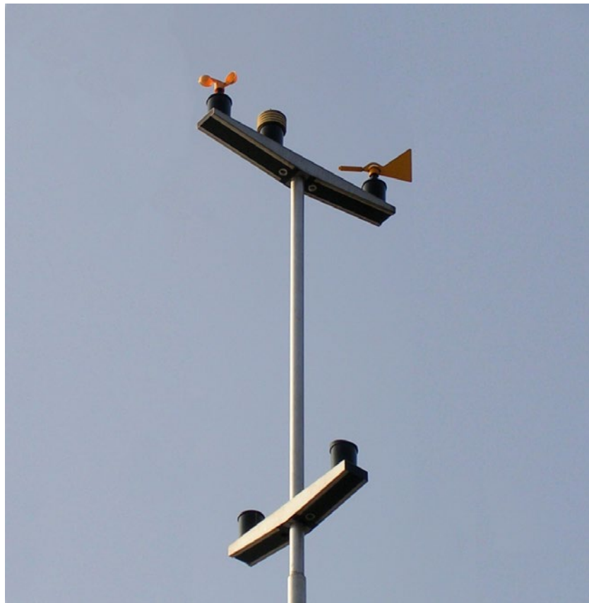
Privat väderstation, med givare för ljus och regn (nederst) och vindriktning, vindhastighet och temperatur (överst).
