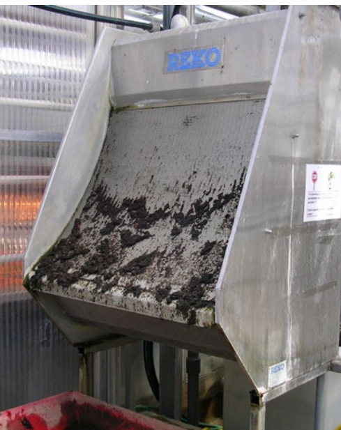
Ett silfilter där vatten släpps på i toppen och fördelas ut över filtrets övre del genom den smala spalten. Vattnet rinner genom filterplåtens hål, medan grova partiklar fastnar och med tiden sköljs längre och längre ner, för att till sist hamna i uppsamlingsbehållaren längst ner.
