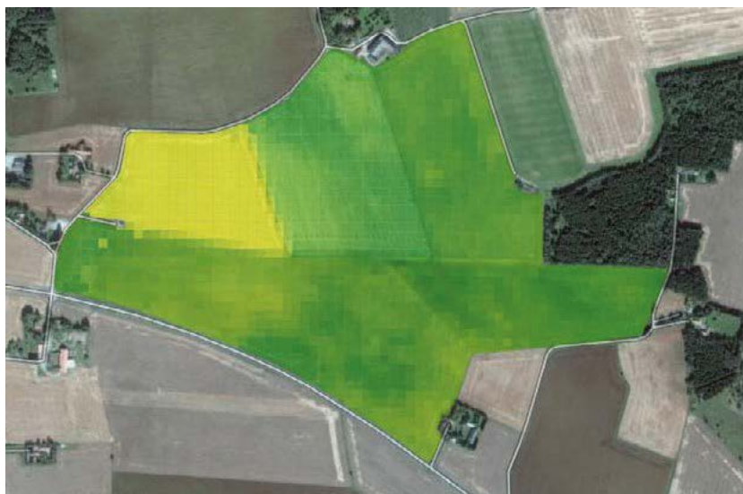
Bild 22. I CropSAT kan du skapa tilldelningsfiler som kan användas för att styra spridare utifrån satellitbilder baserade på vegetationsindex. Foto: Cropsat.se
