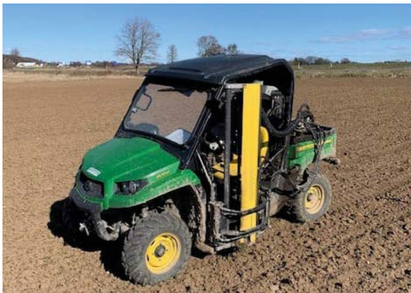
Bild 1. Oftast tas jordprover vid markkartering med jordborr som är monterad på en fyrhjulig. Provpplatsernas positioner fastställs med GPS. Foto: Magnus Westöö
