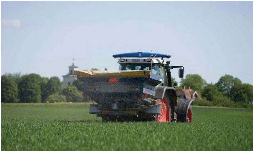
Bild 23. Kvävesensorn på traktorns tak läser av grödans färg och täthet. Gödselspridaren varierar sedan kvävegivan efter grödans behov. Foto: Lantmännen
