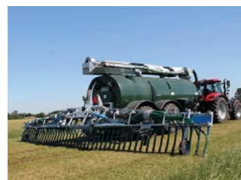
Bild 17. Gödseltunna eller tankvagn är det vanligaste sättet att transportera och sprida flytgödsel. Tankvagnen kan förses med olika typer av spridaraggregat, på bilden en släpfotsramp.
