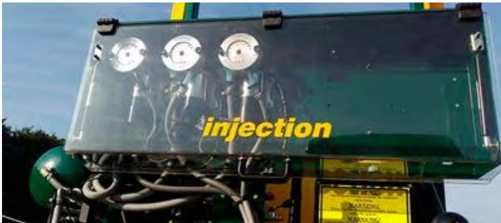
Figur 32. Utrustning för preparatdosering med tre preparat, DSC. Foto: www.danfoil.dk
