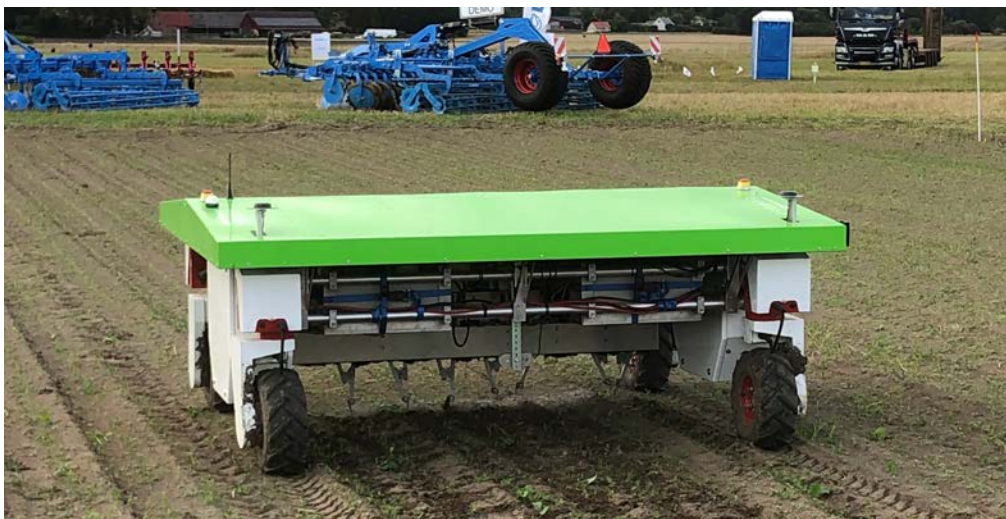
Figur 16. EKOBOT robot som rensar ogräs i lök. Fältdag i Kristianstad sep 2022. Foto: Frans Johnson..
