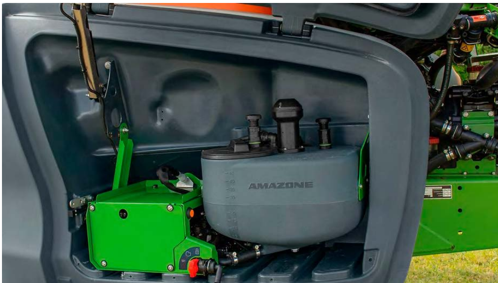
Figur 34. System för preparatdosering via separat tank, DirectInject. Foto: www.amazone.de
