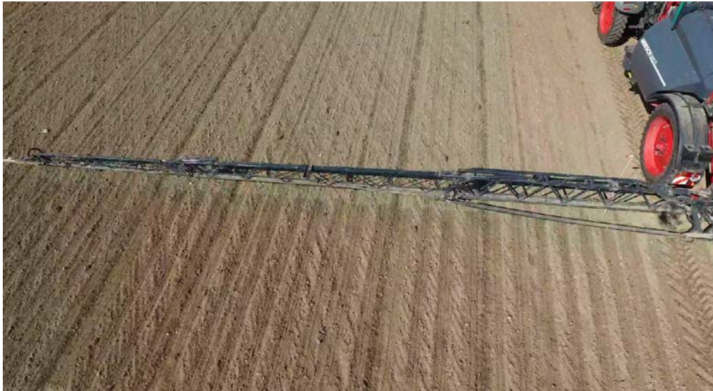
Figur 13. Bomspruta med 25 cm munstycksdelning. Detta ger med GNSS-teknik möjlighet till bekämpning i band, antingen över eller mellan raderna. Bild från försök hos Nordic Beet Research i Danmark.
