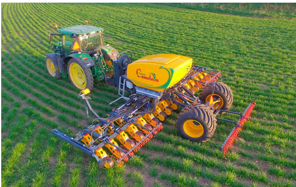
Figur 15. Bogserad radhacka med såutrustning. Foto: www.lyckegard.com
