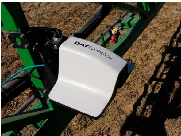
Figur 27. Komplettering av sensorteknik på bomspruta ger möjlighet till on-off styrning av sektioner. Foto: www.dimensionsagri.no
