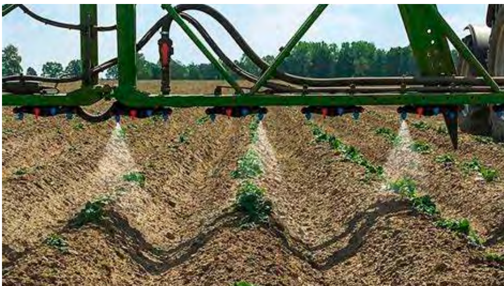
Figur 25. Radspruta kan reducera användningen av växtskyddsmedel. Foto: www.amazone.de
