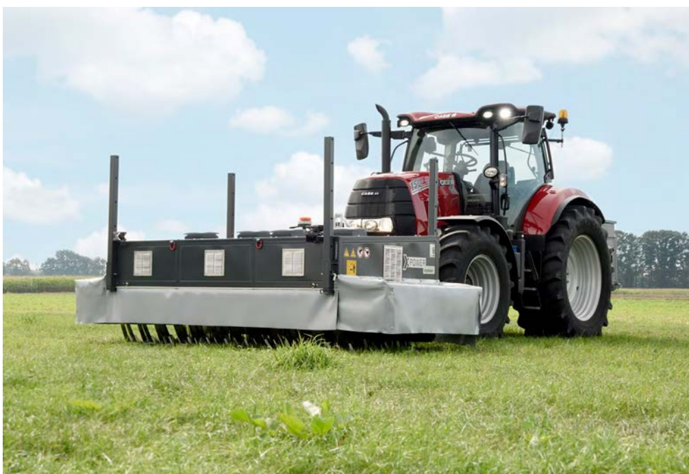
Figur 11. Frontmonterad utrustning för elektrisk totalbekämpning av ogräs. Bild: www.zasso.com
