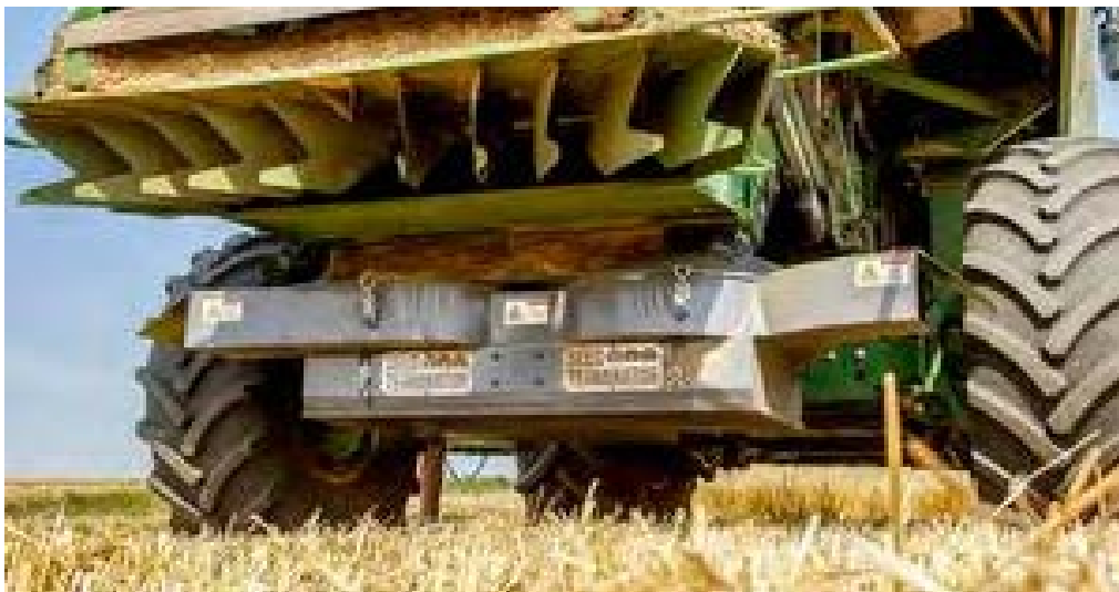
Figur 10. Sönderdelning av ogräsfrön med kvarn. Foto: www.seedterminator.com.au
