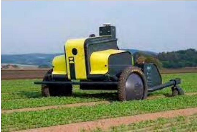
Figur 18. Robot från Kiltersystem med kamera och bläckstråleteknik för kemisk ogräsbekämpning i grönsaksodlingar. Foto. www.kiltersystem.com
