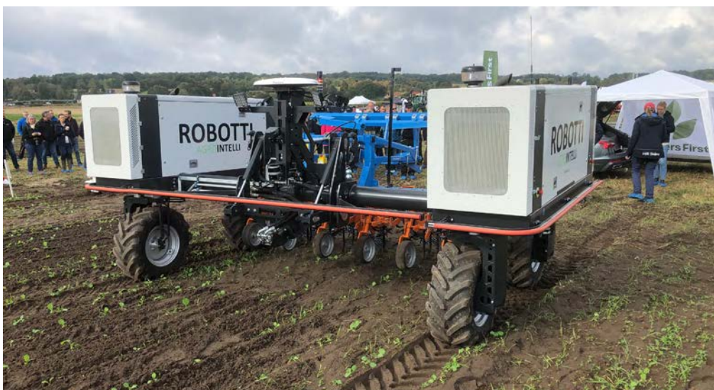
Figur 17. Redskapsbärare från Robotti utrustad för hackning i höstraps. Fältdag i Kristianstad sep 2022. Foto. Frans Johnson.
