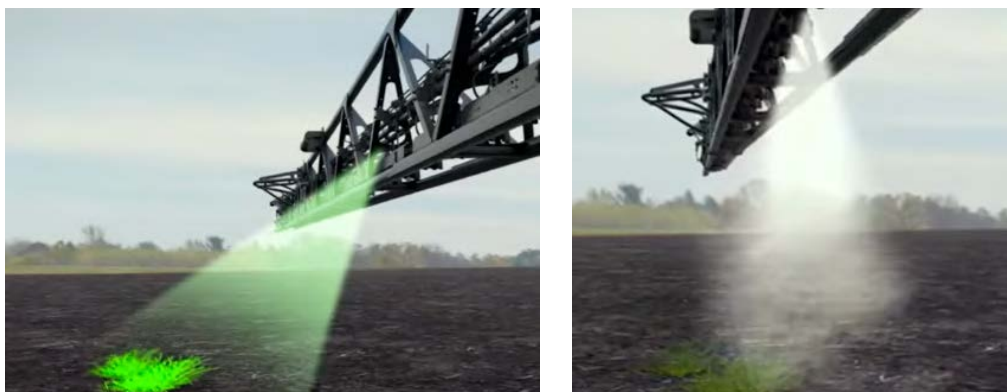
Figur 2. Punktbehandling kan reducera användningen av glyfosat betydligt. Foto: www.deere.com
