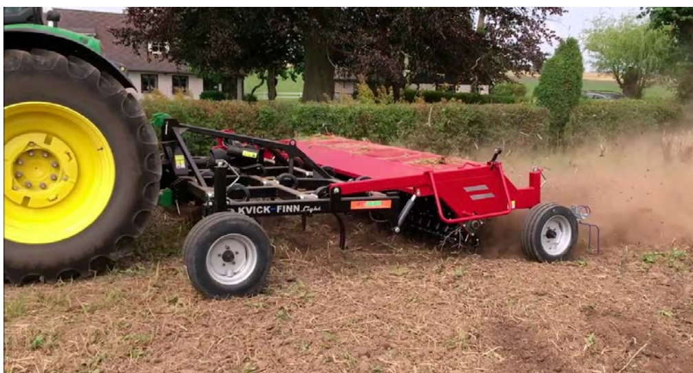
Figur 5. Pinnkultivator med bearbetningsrotor för bekämpning av rotoqräs. Foto: www.lyckegard.com
