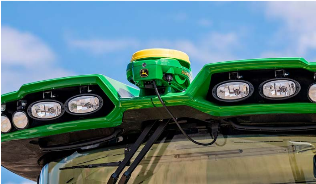
Figur 20. Traktor utrustad för mottagning av RTK-signal. Foto: www.deere.se
