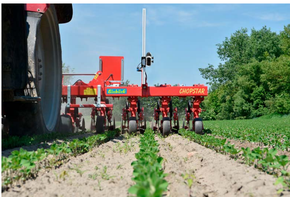
Figur 19. Kamera monterad på radhacka. Foto: www.einboeck.at
