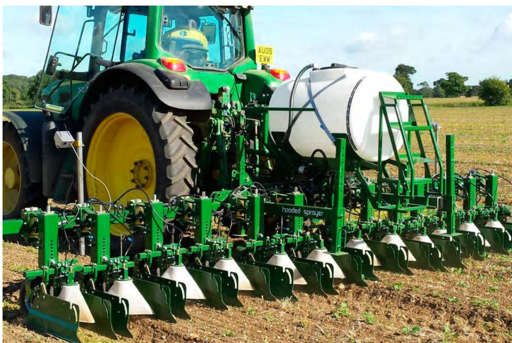
Figur 12. Bandspruta med vridbara huvar för att variera bredden på område som ska behandlas. www.garford.com
