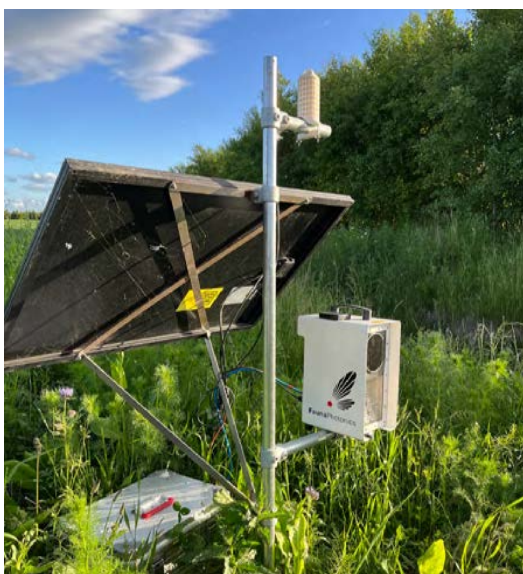
Figur 22. Kamera i fältkanten som registrerar insekter som flyger förbi. Foto: Sunita Hallgren, www.faunaphotonics.com
