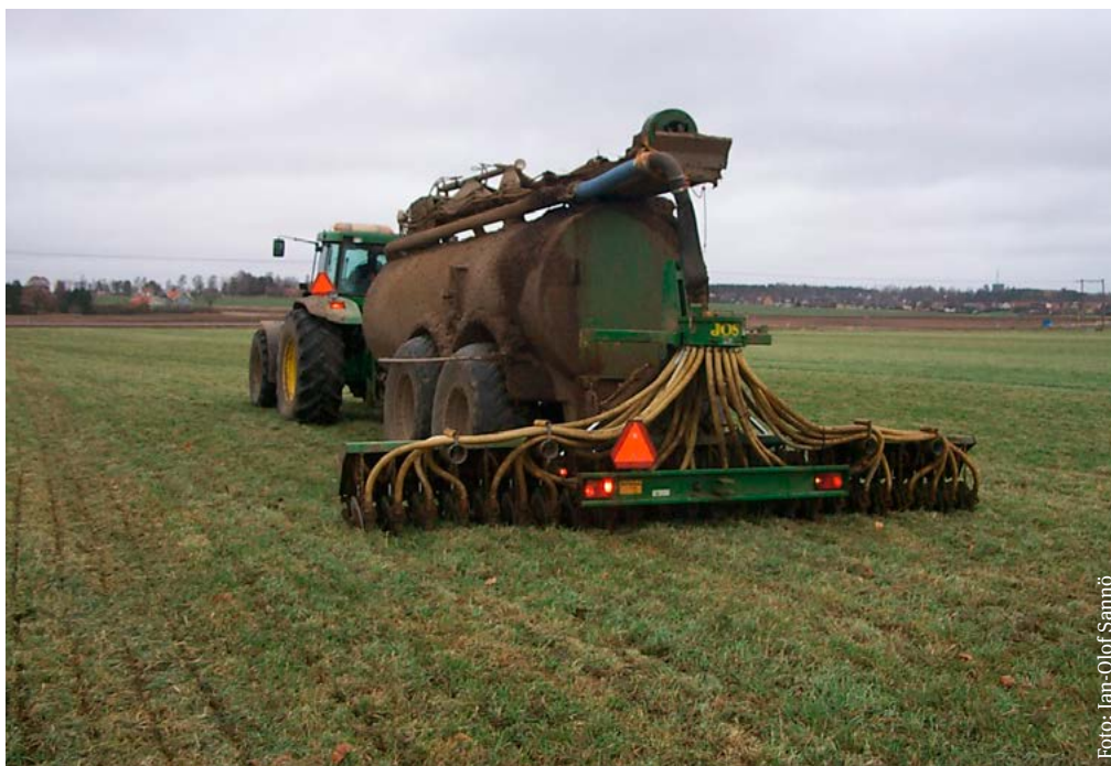
Figur 9. Ytmyllningsaggregat med två v-ställda skivor avsett för vall.
