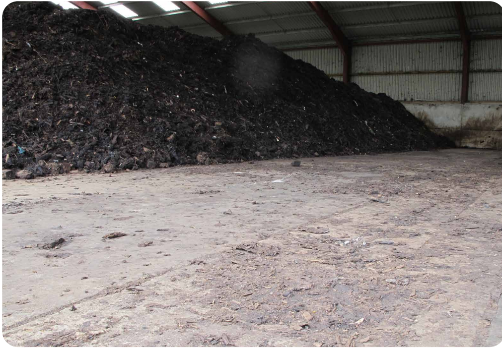
Stationär kompostering med luftningshål i golvet. Foto: Johan Ascard
