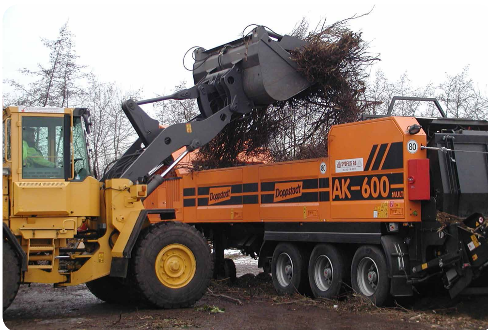
Hårdare material kan sönderdelas med en grenkross. Foto: Christina Johansson
