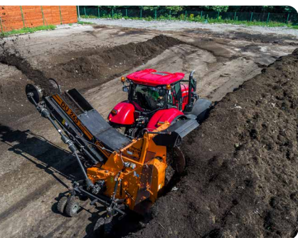
Exempel på kompostvändare som kopplas till traktor. Maskinen flyttar hela strängen i sidled. Denna typ av maskin kostar ungefär 1 100 000 kr. Foto: OP System AB.
