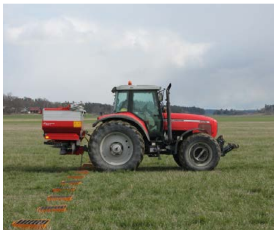
Bild 16. I Greppa Näringen finns möjligheten att genomföra test av mineralgödselspridare. Foto: Christer Johansson.
