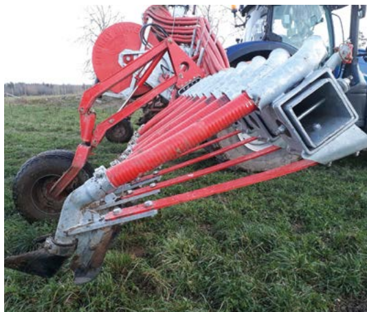
Bild 19. Med släpfot får gödseln en bättre markkontakt. Foto: Johan Malgeryd.
