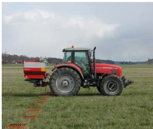
Bild 16. I Greppa Näringen finns möjligheten att genomföra test av mineralgödselspridare. Foto: Christer Johansson.
