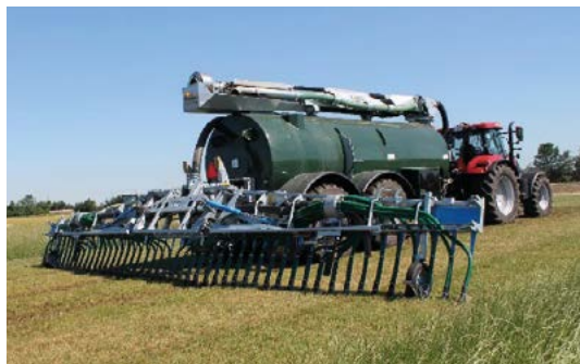
Bild 17. Gödseltunna eller tankvagn är det vanligaste sättet att transportera och sprida flytgödsel. Tankvagnen kan förses med olika typer av spridaraggregat, på bilden en släpotsramp. Foto: Christer Johansson.
