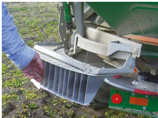
Bild 15. Kantspridningsutrustning minskar risken för att gödsel hamnar utanför fältet. Foto: Jens Blomquist.
