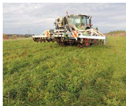
Bild 20. Spridning med matarslang och ytmyllningsaggregat för spridning i vall minskar både markpackning och ammoniakförluster. Foto: Pernilla Kvarmo.
