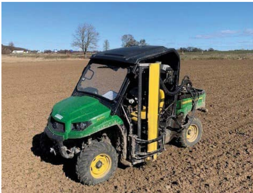
Bild 1. För att ta ut jordprover vid markkartering kan man använda en jordborr som är monterad på en fyrhjuling. Det är bra att fastställa provplatsernas positioner med GPS. Foto: Magnus Westöö.
