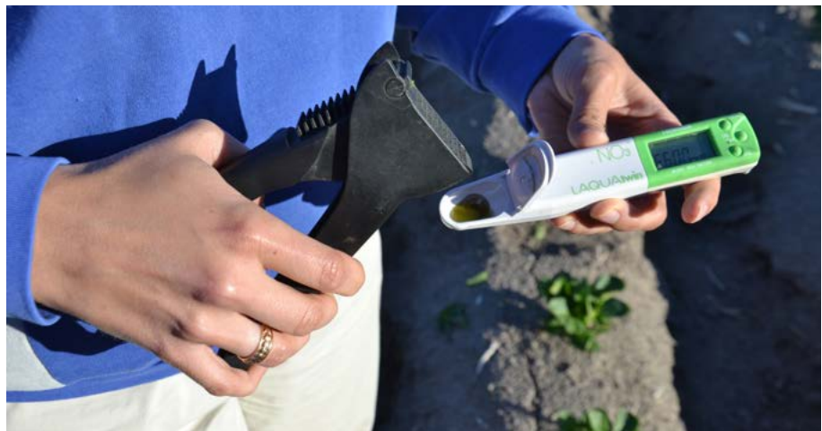
Digital mätare som visar nitrathalten i plantsaft. Foto: Åsa Rölin.
