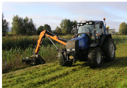
För att komma åt vid branta slänter fungerar en slaghack monterad på arm.
