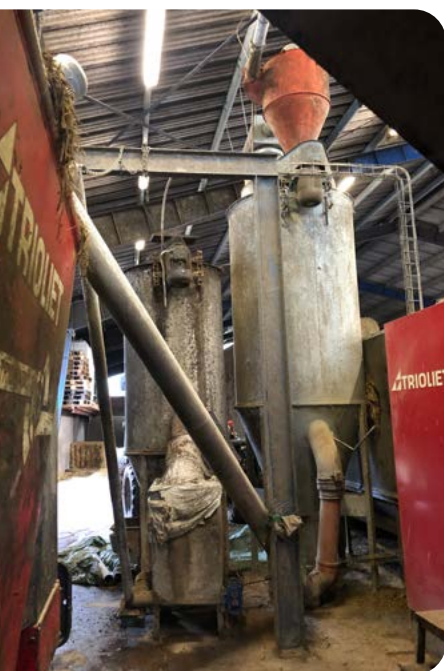
Fodermixen, som består av av första, andra och tredje vallskörd, en blandning med mald spannmål och åkerböna, mineraler och lite halm, tillreds av en Trioliet fodermixer.
