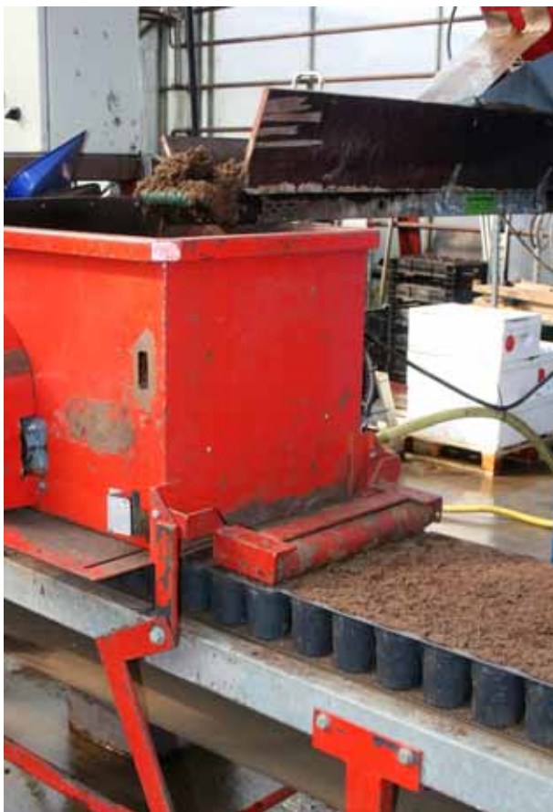
Storskalig anläggning för fyllning och sådd av krukkulturer, här hanteras substratet i bulk. Foto: Christina Winter.
