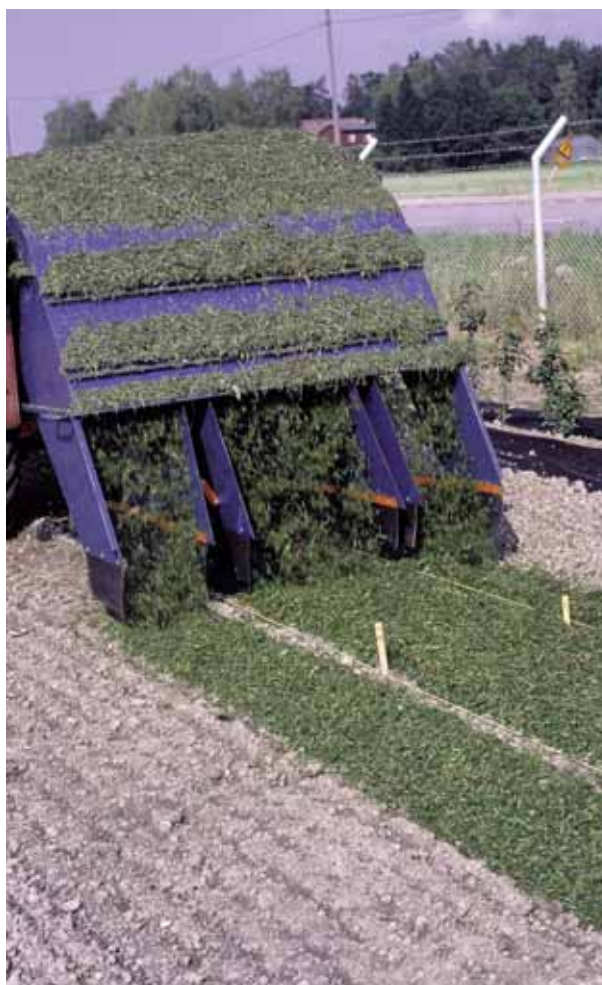
Figur 1. Stallgödselspridare med aggregat för kompostspridning, vilken testades i försök på Alnarp vid utläggning av grönmassa. (Foto: LT, Alnarp)
