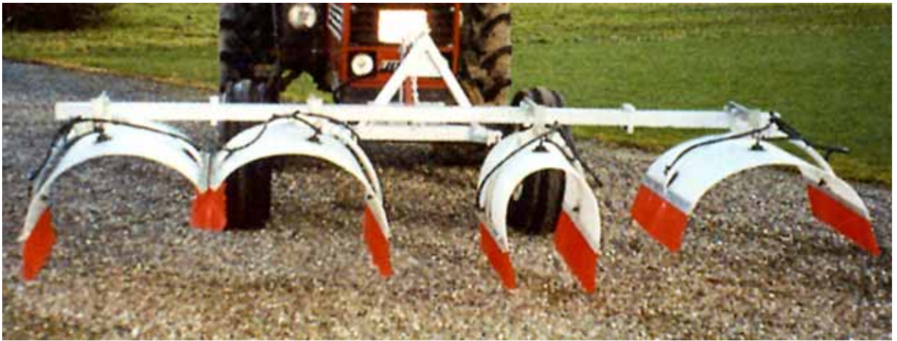
Figur 3. Bandspruta med möjligheter att variera radbredd och radavstånd (Klip-Klap). (Foto: Skovhave, www.skovhave.dk )
