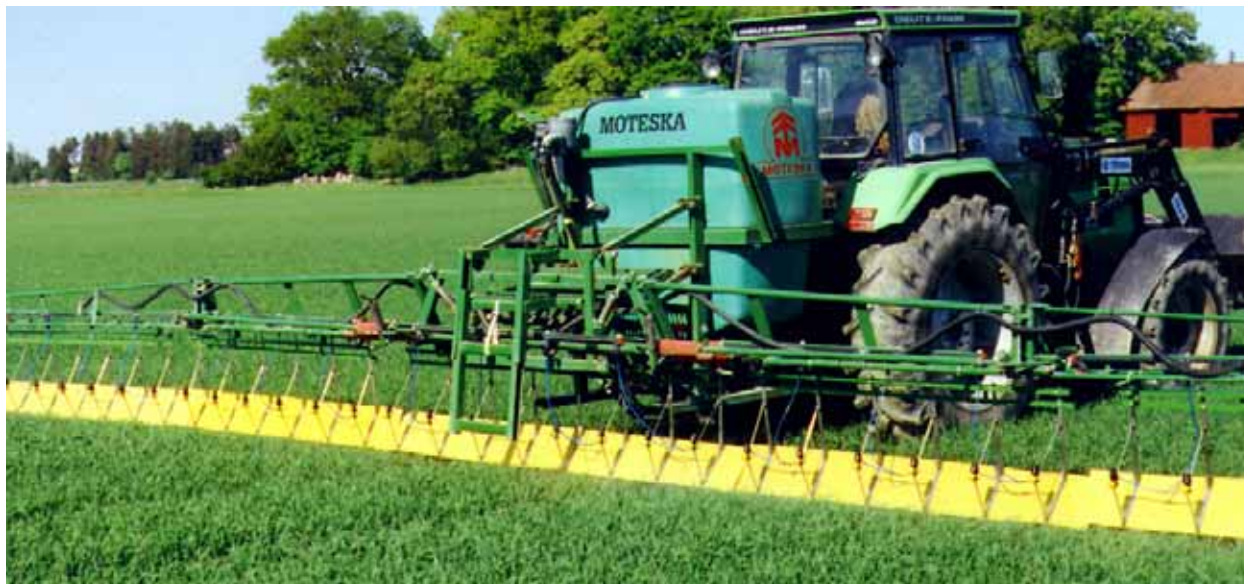
Figur 1. Släpduk öppnar upp växtbeståndet och ökar nedträngningen av preparatvätskan i annars svårnådda delar av växtbeståndet (foto tillhandahållet av Acanova, Uppsala).
