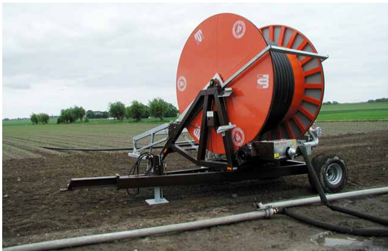
Figur 3. Bevattningsmaskin för bevattning med ramp eller storspridare. (Foto: RMV, Kristianstad)
