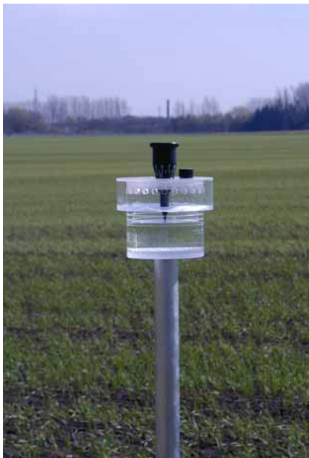
Figur 1. Med en avdunstningsmätare kan den dagliga vattenförlusten från grödorna enkelt bestämmas.
