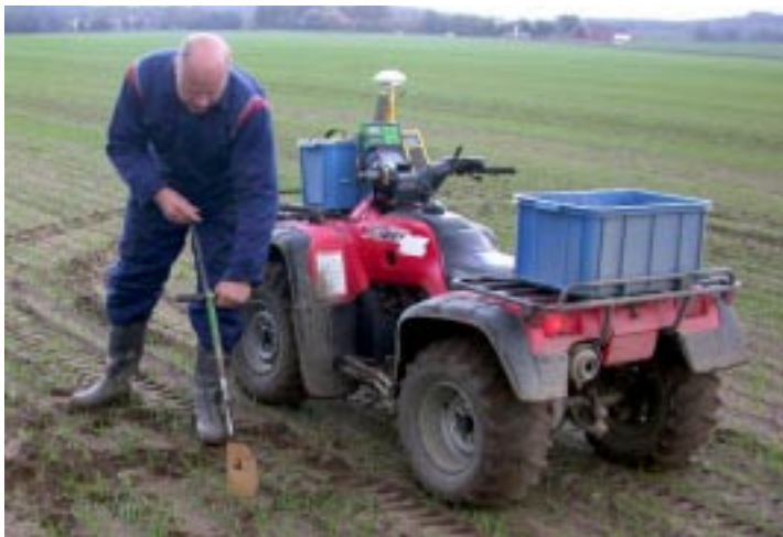
Vid uppföljningskartering används markkartan och en GPS-mottagare för att lokalisera provplatserna.
